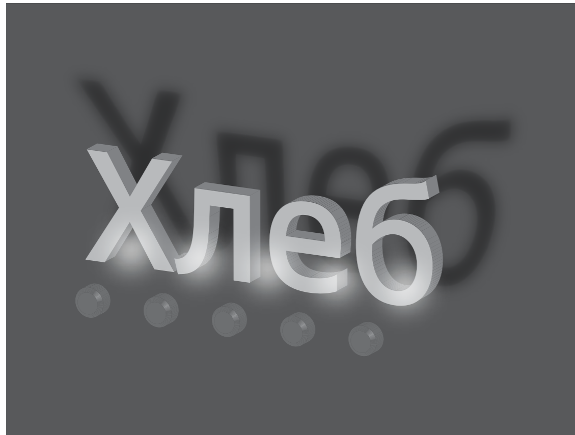
Рис. 4-25. Вывеска освещается софитами спереди
