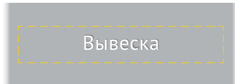
Рис. 2-62. Условное обозначение витринной вывески из отдельно стоящих букв и знаков на подложке, принятое в АХК и используемое в этом альбоме. Пунктиром ограничена максимально допустимая зона для размещения элементов вывески на фоне остекления витрины
