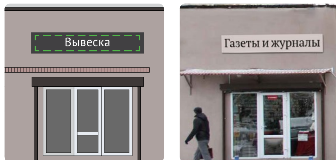
Рис. 2-16. Обозначение вывески в АХК (слева) и реальная вывеска, соответствующая этой схеме (справа)
