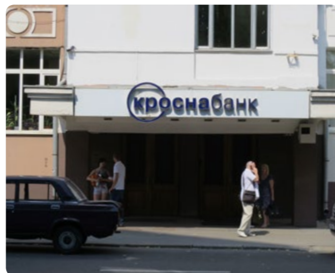
Рис. 2-78. Плохо: тонкие выносные элементы вывески выходят за габариты фриза
